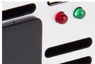
При включване свети зеления индикатор. Червеният указва претоварване, обратно включване или претоварване.
